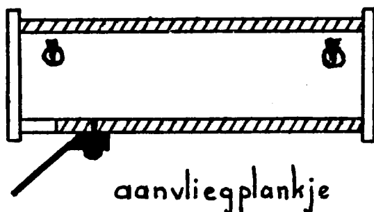
Figuur 1. Doorsnede van een gierzwaluwenkast met een aanvlieg/oploopplankje.
