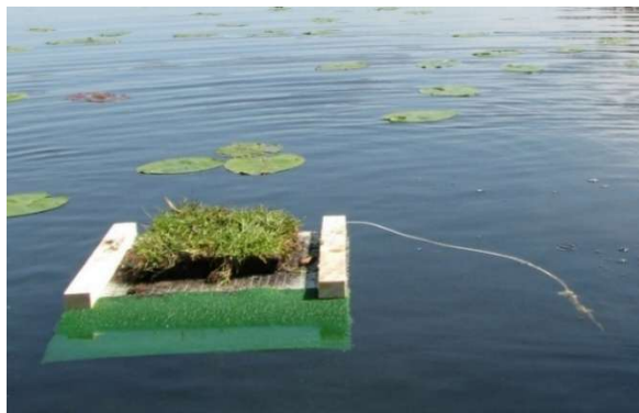
Vlotje van hout zonder opstaand rekje
